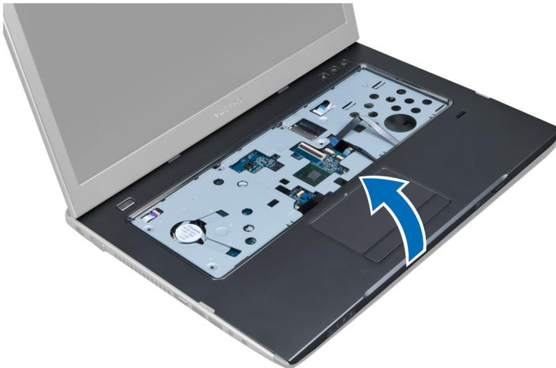
11. Schieben Sie die Handballenstütze nach außen und heben Sie sie an, um sie aus dem Computer zu entfernen.
