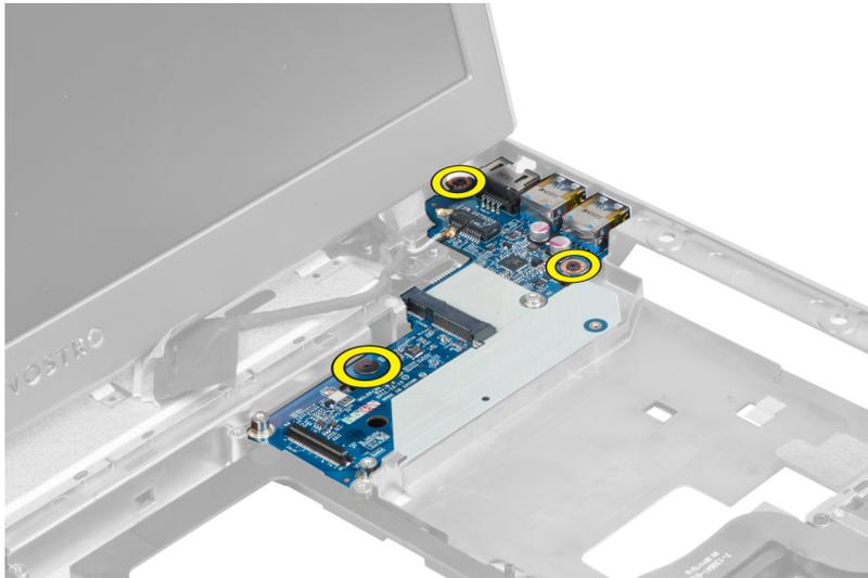
4. Heben Sie die LAN-Platine an und entfernen Sie sie aus dem Gehäuse.
