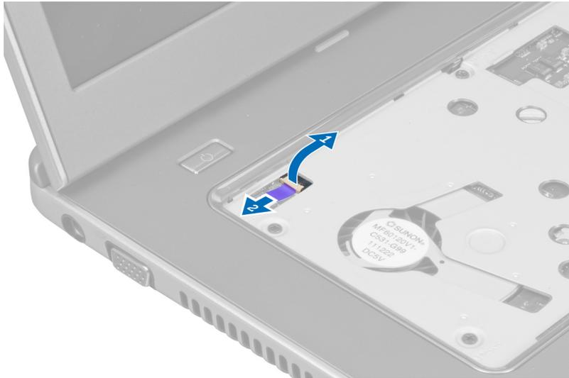
8. Heben Sie die Lasche an und lösen Sie das Touchpad-Kabel, das Kabel des SD-Speicherkartenlesers und das Fingerprint-Scanner-Kabel vom Computer.
