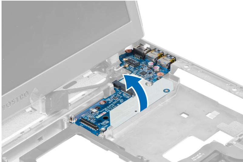
5. Ziehen Sie die LAN-Platine heraus und entfernen Sie sie aus dem System.
