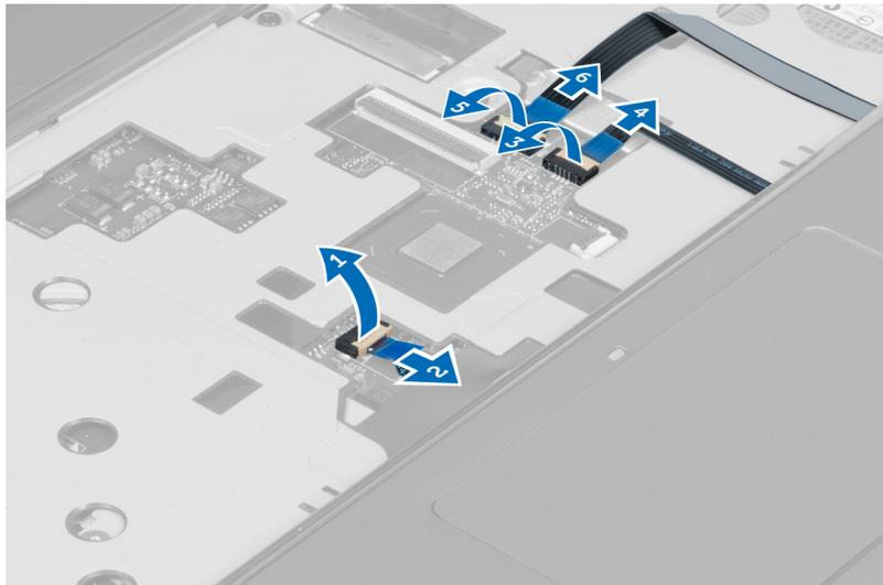
9. Heben Sie die Lasche an und trennen Sie das Funktionsschaltflächenkabel vom System.
