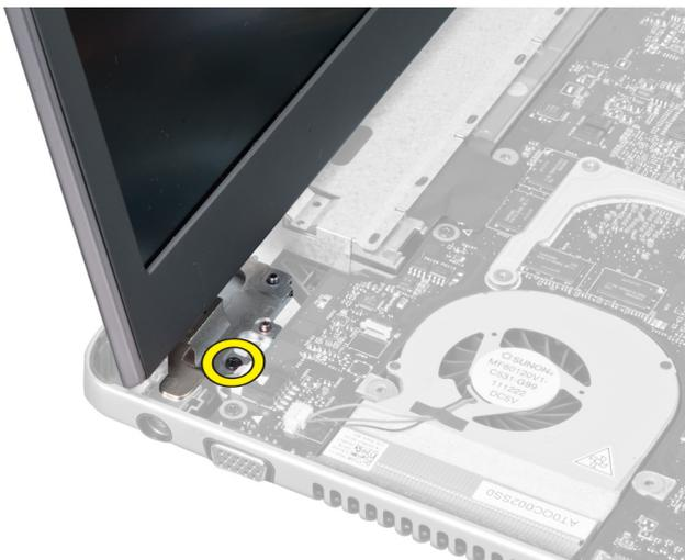
6. Wickeln Sie das Kamerakabel ab und entfernen Sie die rechte Schraube, mit der die Bildschirmbaugruppe befestigt ist.
