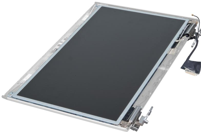
3. Entfernen Sie die Schrauben, mit denen die Bildschirmhalterung an der Bildschirmbaugruppe befestigt ist.
