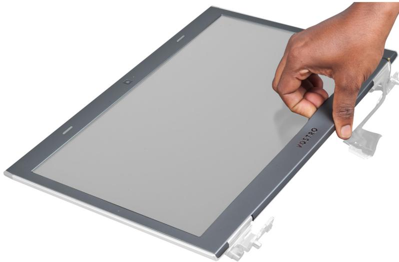
4. Heben Sie die Bildschirmblende an und entfernen Sie sie aus der Bildschirmbaugruppe.
