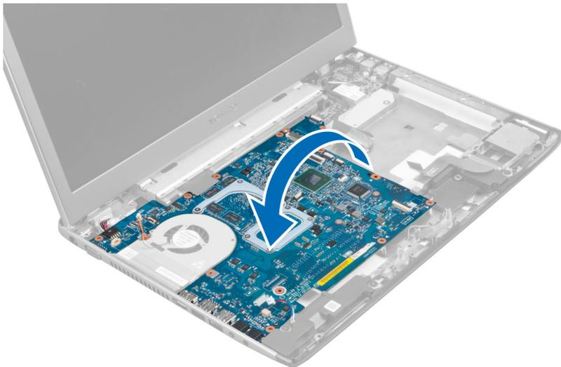
10. Schieben Sie die Systemplatine nach rechts und entfernen Sie sie aus dem Gehäuse.
