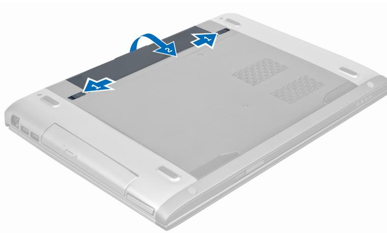
3. Heben Sie den Akku hoch und entfernen Sie ihn aus dem Computer.
