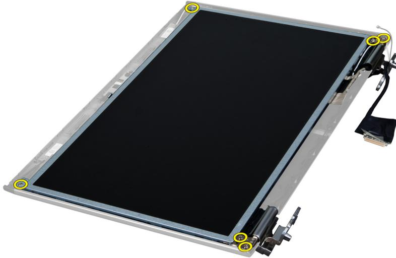
4. Heben Sie den Bildschirm mit den Halterungen und Scharnieren an und entfernen Sie diese Komponenten.
