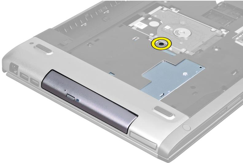
4. Hebeln Sie das optische Laufwerk vorsichtig mit einem Schlitzschraubenzieher aus dem Computer heraus.
